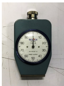
รูปที่ 3.7 เครื่องทดสอบความแข็ง (Durometer Hardness Machine)
