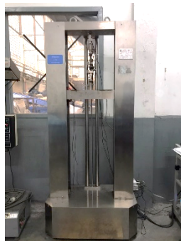
รูปที่ 3.6 เครื่องทดสอบความทนต่อแรงดึง (Tensile Strength Tester)
