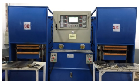
รูปที่ 3.5 เครื่องอัดเบ้า (Compression Molding Machine)
