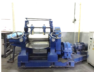
รูปที่ 3.2 เครื่องบดผสมยางสองลูกกลิ้ง (Two roll mill)
