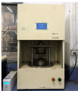
รูปที่ 3.3 เครื่องทดสอบคุณสมบัติการคงรูปของยาง (Moving Die Rheometer)
