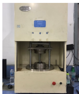
รูปที่ 3.4 เครื่องทดสอบความเหนียวของยาง (Mooney viscometer)
